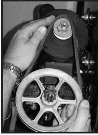
Fig.20: Faire glisser la courroie d'entraînement sur les poulies.
