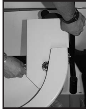
Fig.36: Replacer le tambour mélangeur.
