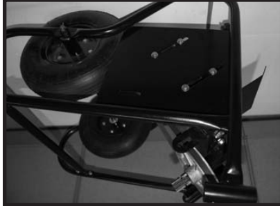
Fig.29: L'ensemble du cadre avec la courroie d'entraînement, l'ensemble d'entraînement et le moteur.
