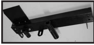
Fig.5: Bonne emplacement et orientation du support de tambour.
