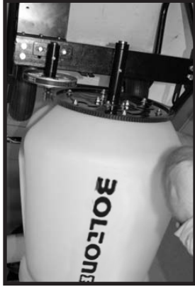
Fig.32: Vérifier que l'engrenage du tambour et de l'entraînement est aligné correctement.
