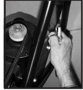
Fig.24: Desserrer le boulon sur le jackshaft pour changer ajuster l'ensemble d'entraînement.
