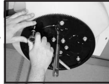
Fig.11: Glisser le boulon à travers l'attachement du tambour mélangeur en tournant le tambour sur son côté.
