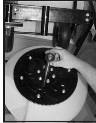
Fig.30: Glisser une rondelle sur l'arbre du tambour.
