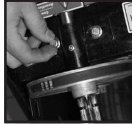
Fig.22: Serrée les boulons sur la plaque d'ajustement avec les doigts.
