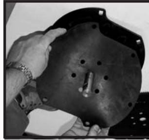
Fig.9: Aligner les trous sur le coussin de caoutchouc et la plaque.
