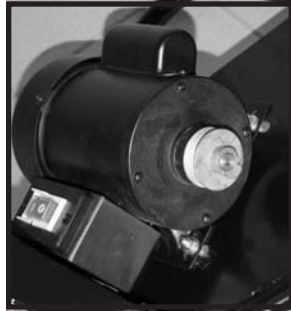
Fig.16: Fixer le moteur sur les guides sur le côté gauche du cadre.
