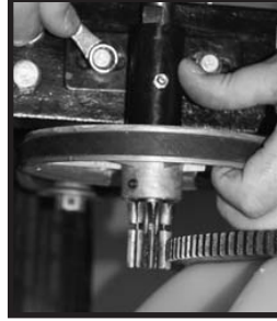
Fig.22: Serrée les boulons sur la plaque d'ajustement avec les doigts.
