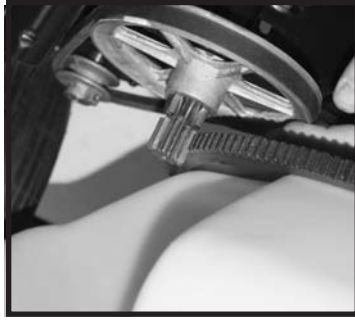
Fig.31: Placer le tambour mélangeur sur le montant du support.
