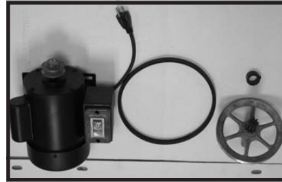
Fig.14: Pièces requises pour monter le moteur et l'ensemble d'entraînement.
