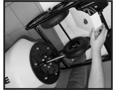
Fig.35: Enlever le tambour mélangeur de la base et placer le garde en plastique pour le moteur et la poulie par-dessus le mécanisme d'entraînement.
