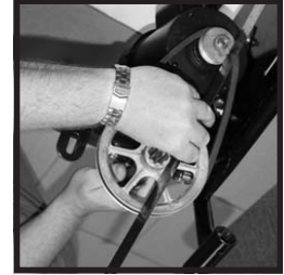
Fig.21: Utiliser une règle comme guide pour ajuster la courroie.
