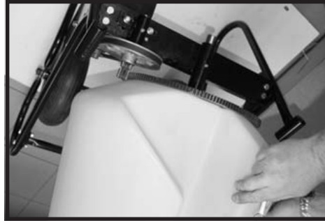
Fig.30: Glisser une rondelle sur l'arbre du tambour.
