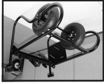
Fig.6: La plaque de soutien du Jackshaft doit se déplacer librement avec l'entaille de position.
