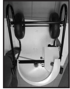
Fig.35: Enlever le tambour mélangeur de la base et placer le garde en plastique pour le moteur et la poulie par-dessus le mécanisme d'entraînement.
